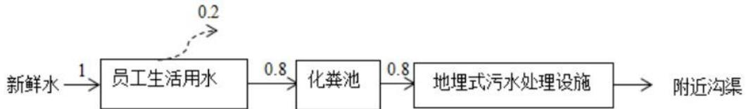
图 1 项目水平衡图 单位：t/d
