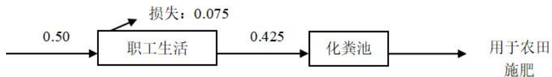
图 1 现有项目水平衡图 单位：t/d
