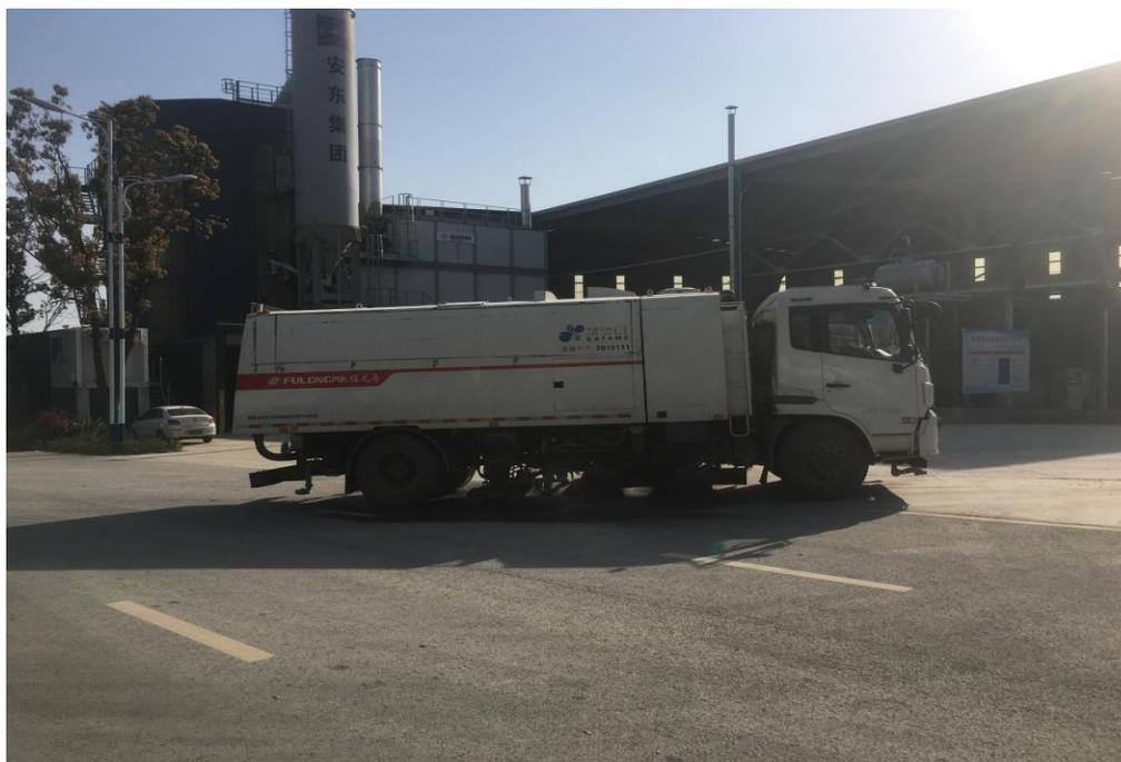
图3-12 洒水车（洒水抑尘措施）
